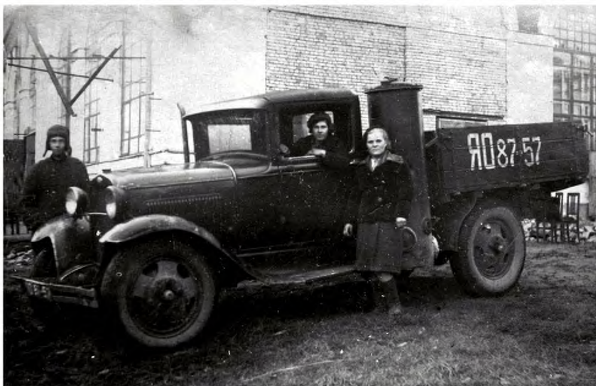
Автомобиль горэлектросети с газогенератором (стоит водитель Евдокия Коробицина)
